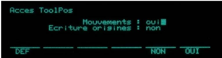
Vous pouvez définir si l'exécution de mouvement et l'écriture des origines dans l'écran ToolPos est admis sans mot de passe ou clé de sécurité.
