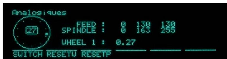
Permet le test de la roue électrique, ainsi que des potentiomètres du clavier.
