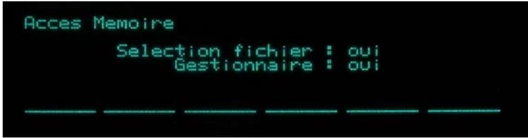
Ces paramètres permettent de définir si l'utilisateur sans mot de passe ou clé de sécurité peut sélectionner ou manipuler des fichiers au sein de l'écran MEM.
