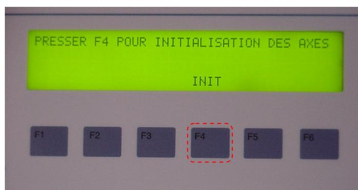
Fermer les portes et presser la touche F4 (INIT) pour l'initialisation des moteurs. Le porte-panier s'arrête à la position de chargement au-dessus du compartiment de séchage.
